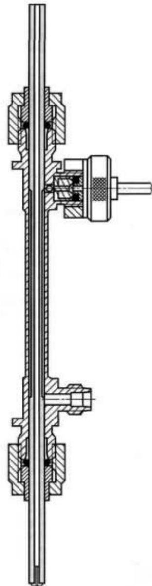
Рисунок А2.2 — Сборочный чертеж испытательной секции трубки подогревателя
